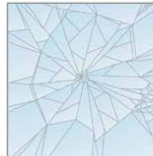
Ejemplo de fragmentación del vidrio laminado
